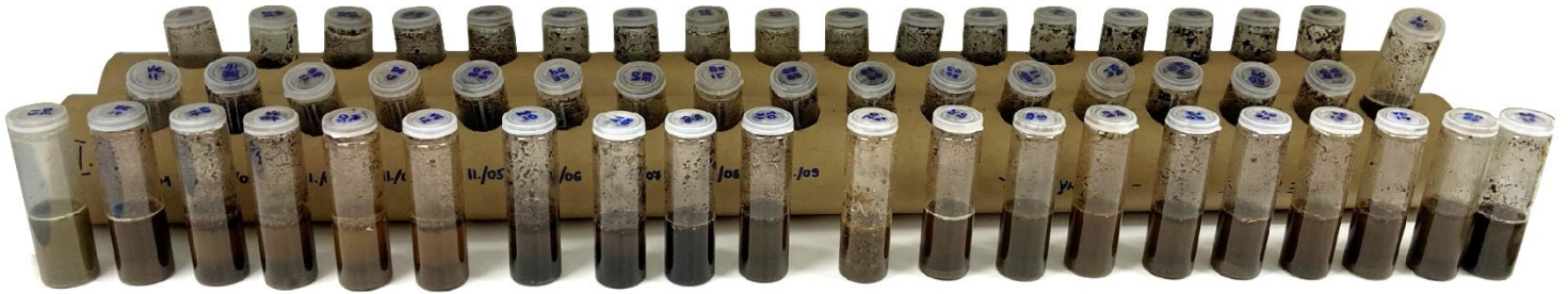
Figur 8. Jordprøvene for pH etter risting (glass med ca.10 ml jord og 25 ml destillert vann).
