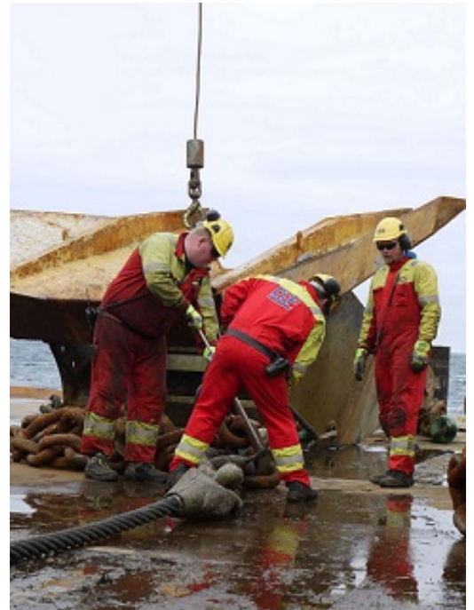
Mannskap på dekk håndterer et stort anker med kjetting, som brukes til å feste mobile borerigger. (Foto: Jan R. Jonassen)
