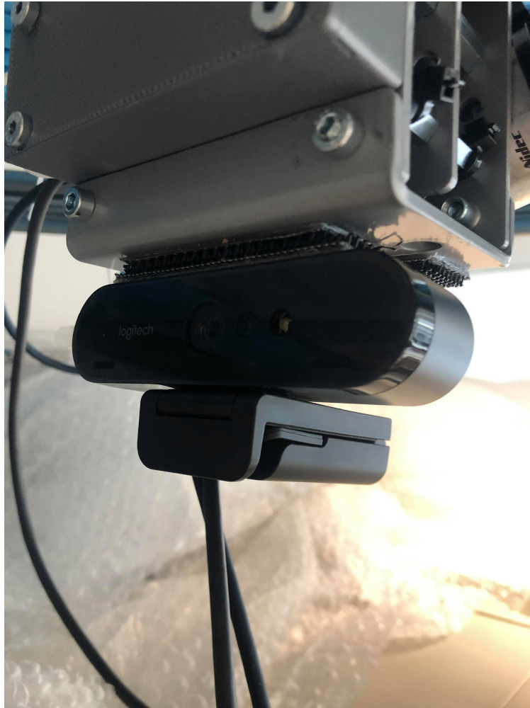
Figur 3k: Webkamera festet på poden.
