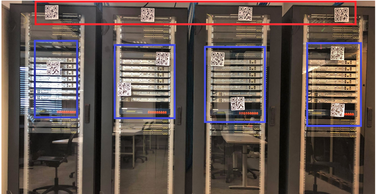
Figur 4a: Oppsett av QR-koder
