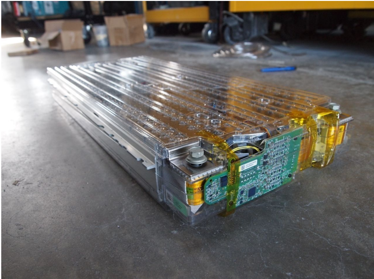
Figur 7: Bilde av en batterimodul (Finn, 2021). Bygget opp av 444 sylindriske battericeller med betegnelsen 18560. Batterimodulen inkluderer sikringer, temperatursensorer og elektronikk for overvåking og styring.
