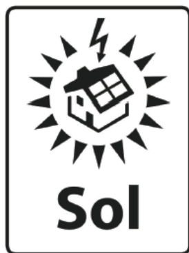
Figur 27 NEK 400 [47]: Merking på bygning hvor det er installert en solcelleinstallasjon
