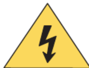
Figur 28 NEK 400 [47]: Merking på DC-siden i et solcelleanlegg
