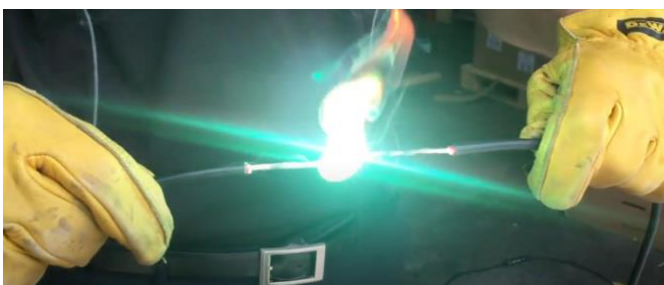
Figur 21 AC Solar Warehouse: Lysbue bildeserie, lysbue oppstår
