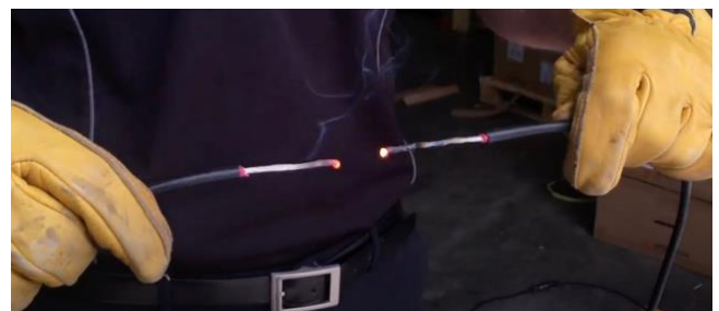
Figur 22 AC Solar Warehouse: Lysbue bildeserie, kabler fra hverandre og lysbue opphører
