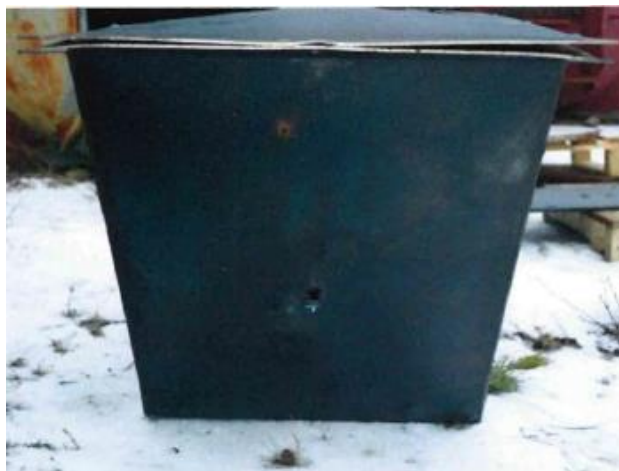
Figur 18: Utgångshållet i dieseltanken från RSV-strålen från experimentet 2019 [18]
