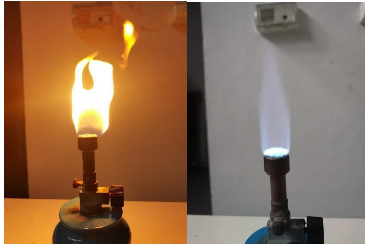
Figur 3: Till vänster: diffusionsbrand och till höger: förblandad brand
