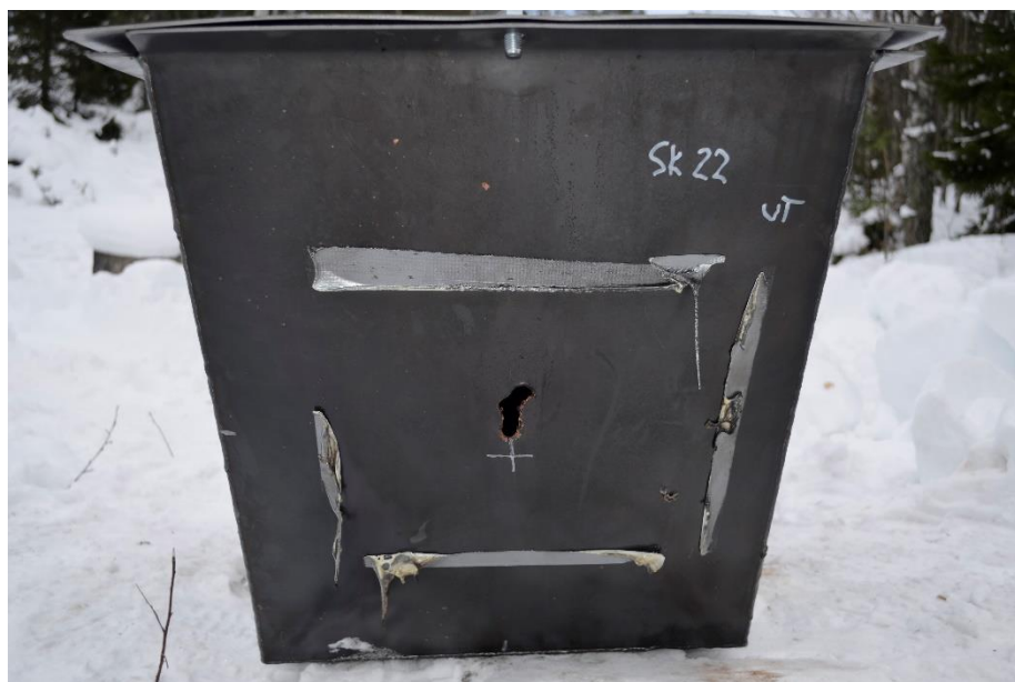
Figur 29: Utgångshållet från RSV-strålen i dieseltanken från experimentet 2021
