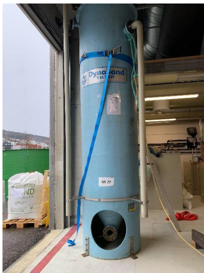
Figur 15: Det selvaskende sandfilteret som ble brukt i pilot- testen, det var et frittstående sandfilter. Bildet tatt på RAS-lab.
