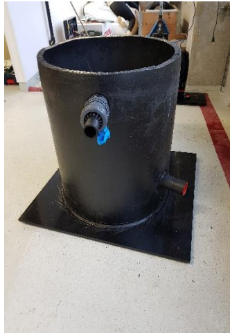
Figur 12: Pumpesumpen som ble brukt i pilot-testen, bildet er tatt på RASLab.
