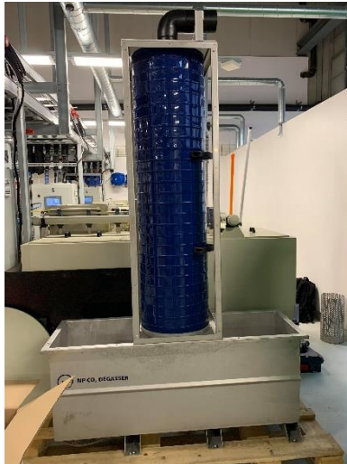
Figur 16: Bildet av CO2 lufteren som ble brukt i pilot-testen.
