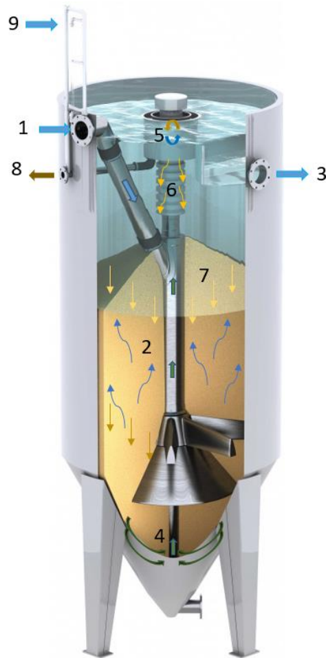
Figur 6: DynaSand sin prototype av det selvvaskende sandfilteret som skal brukes på Litus Akva sin test-rigg. [19]
