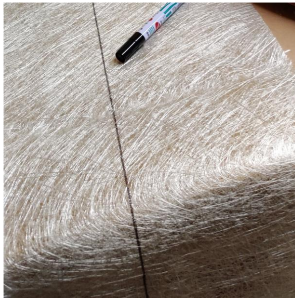
Figur 2.3 CSM matte benyttet for ytre og indre lag
