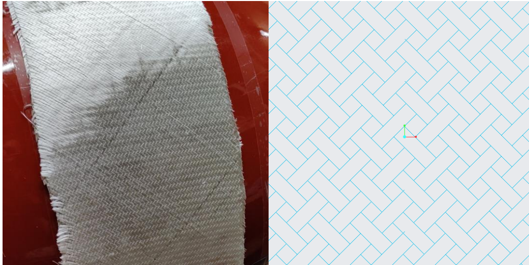
Figur 2.4 Biaxial fibermatte på Egget
