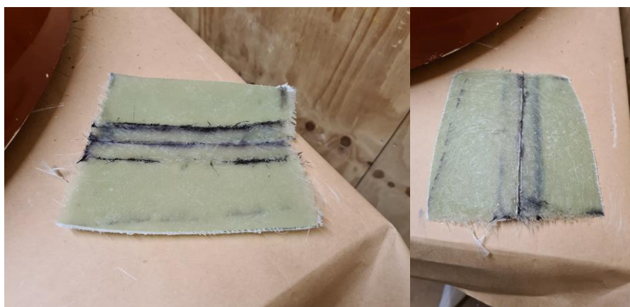
Figur 3.13: Resultat av sammenføyningsmetode med sorte tusj merker
