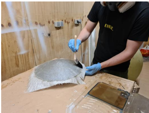
Figur 3.16: Laminering av bunn
