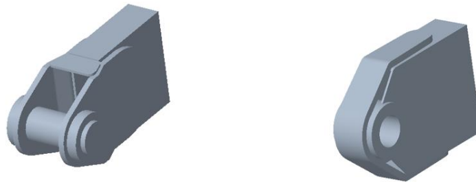
Figur 38: Originale modeller av han- og hunhengsel presentert uten sveiser og festebolter.
