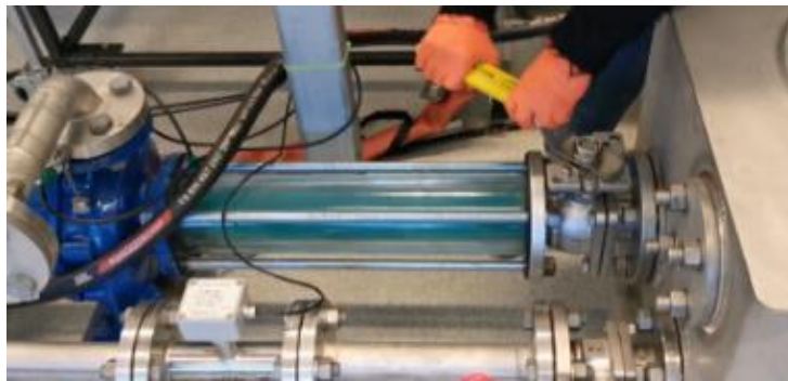
Figur 10 – Laminær vannstrøm uten kavitasjon
