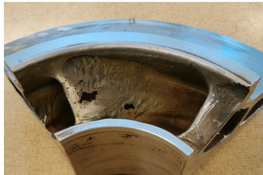
Figur 15 - Impeller utsatt for kavitasjon
