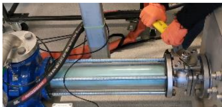
Figur 11 – Turbulent vannstrøm med kavitasjon
