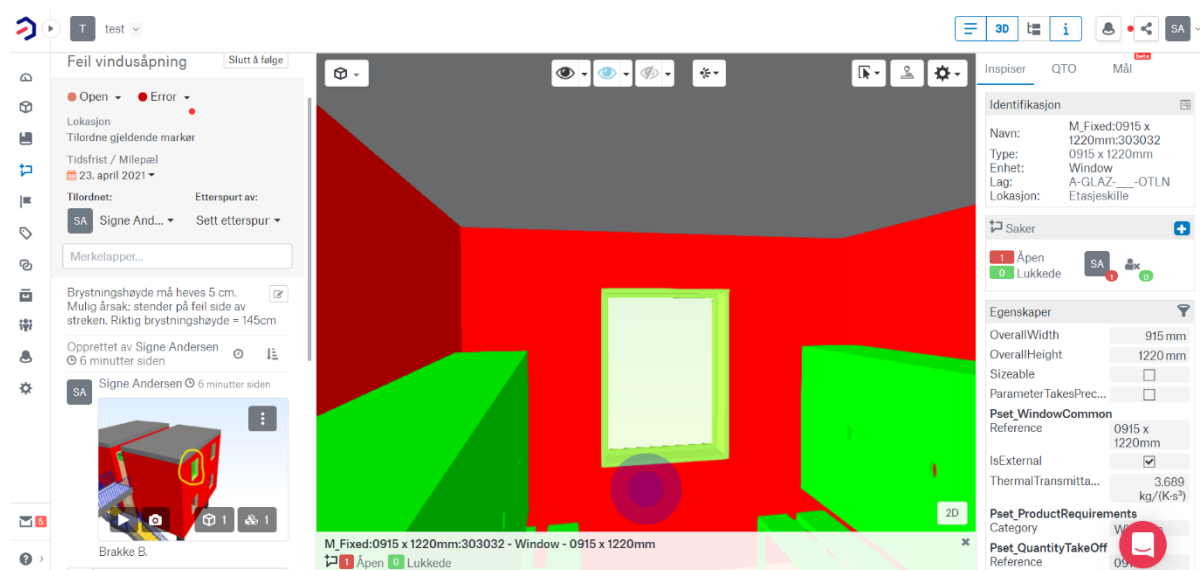
Figur 7 Skjermbilde av en modell i BIMsync. Åpnet med IFC fil. Modellen er opprinnelig modellert i Revit. (modell: privat skoleoppgave fra BYG119 - H19)
