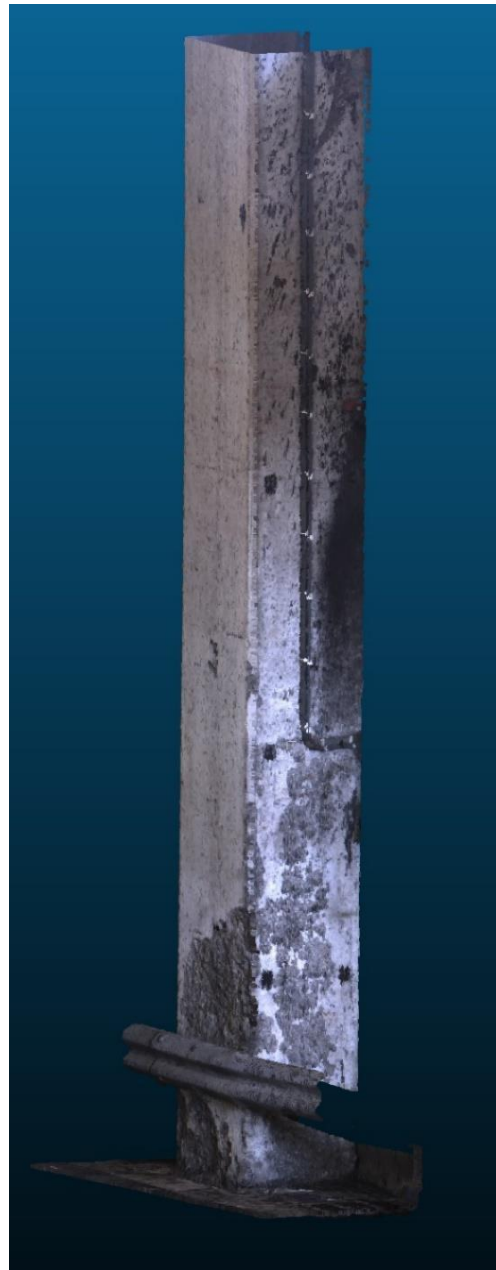
Figur 24 – Brannskadet søyle skannet med Leica ScanStation P20
