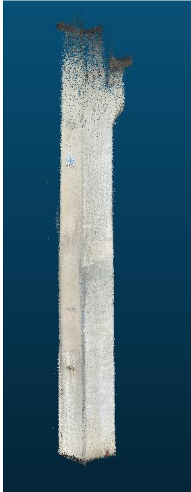
Figur 15 - Ferdig behandlet punktsky i CloudCompare
