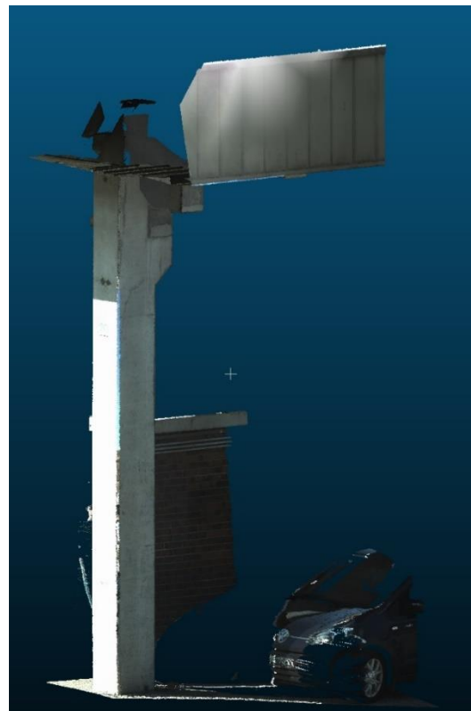
Figur 19 - Søylen skannet med Leica ScanStation P20
