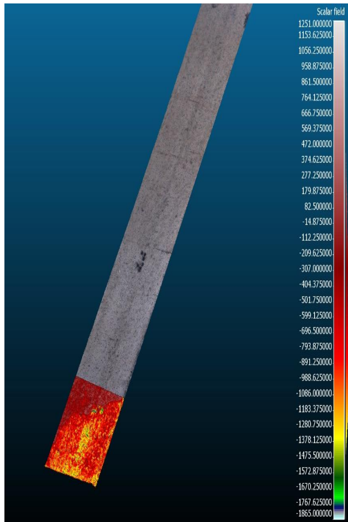
Figur 26 – Høydekurve av skadet område
