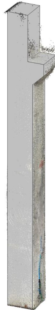
Figur 17 – Modellert søyle i Revit over punktsky Målsatt
