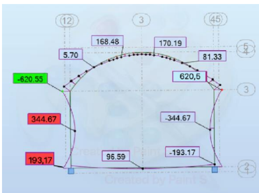
Figur 22: Dimensjonerende momentdiagram snitt 4 ULS 1.
