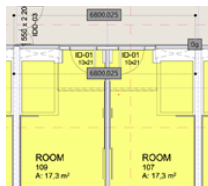
Figur 30 Spennvidde mellom bærende vegger, sett ovenfra [1].
