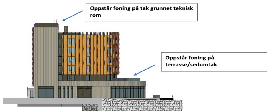
Figur 14 Områder hvor det oppstår fonning i tillegg til statisk snølast [1].
