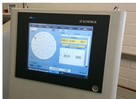
Figur 40: Målingen blir så gjennomført, resultatet blir deretter vist på displayet (Schenck, 2021)
