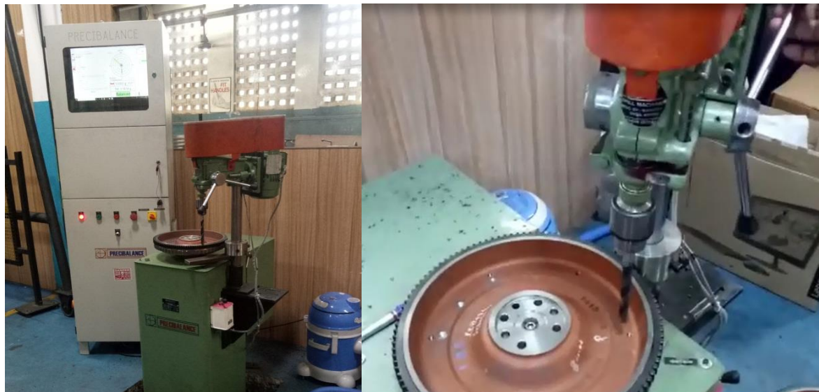
Figur 24: Oppsett av balanseringsmaskin V10-1S (Precibalance, 2021)
