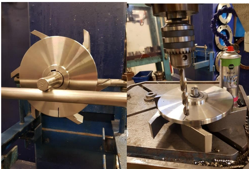
Figur 19: Impeller på et balansestativ, og impeller klar for boring. foto: Theodor D Hansen
