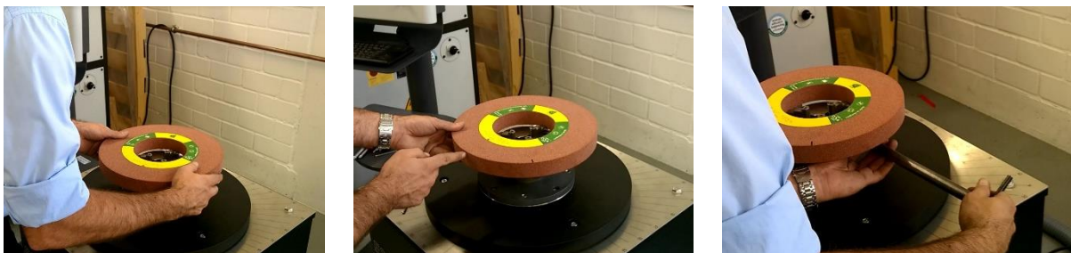
Figur 37: Impeller settes fast og sentreres med en type nøkkel (schenck, 2021)
