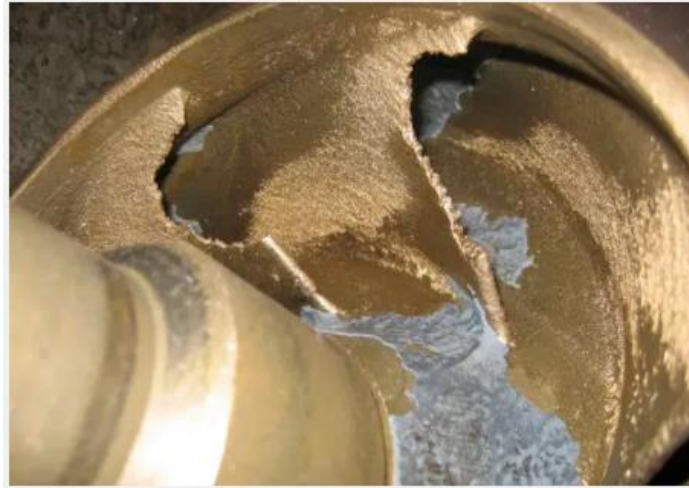
Figur 11: Skade på grunn av vibrasjon (Anspach, 2011)
