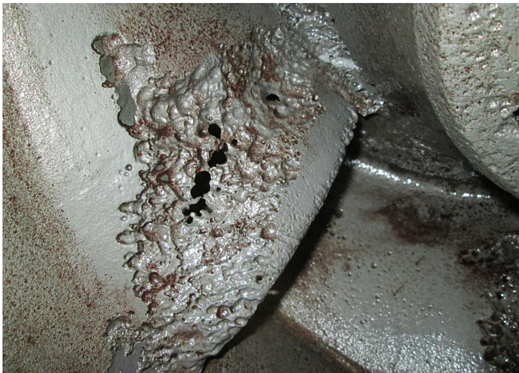
Figur 18: Illustrasjon av skader på grunn av kavitasjon (Fluidhandling, 2019)
