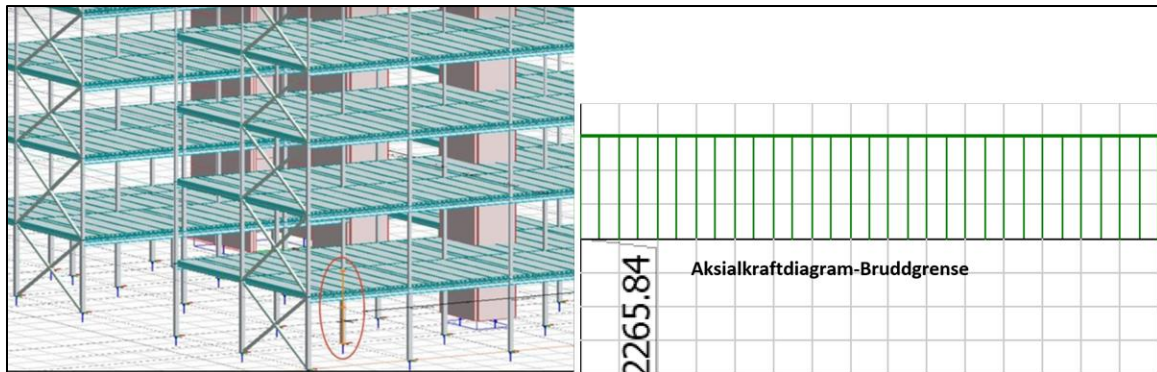
Figur 53 - Posisjon til søylen VKR 250x250x8, med tilhørende aksialkraftdiagram i FEM-design
