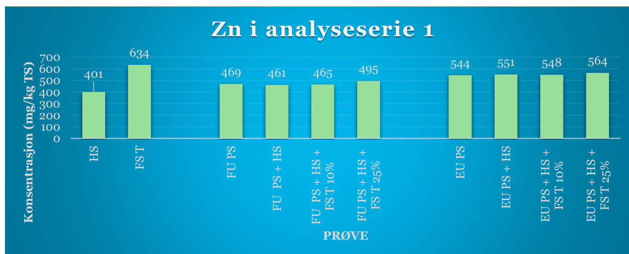
Figur 10: Konsentrasjon av Zn i analyserte prøver i forsøksserie 1. Maksimumsgrense for kvalitetsklasse II i gjødselsvareforskriften (15) for Zn er 800 mg/kg TS.
