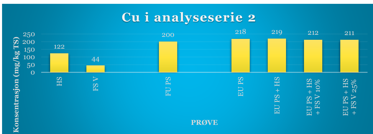
Figur 13: Konsentrasjon av Cu i analyserte prøver i forsøksserie 2. Maksimumsgrense for kvalitetsklasse II i gjødselsvareforskriften (15) for Cu er 650 mg/kg TS.
