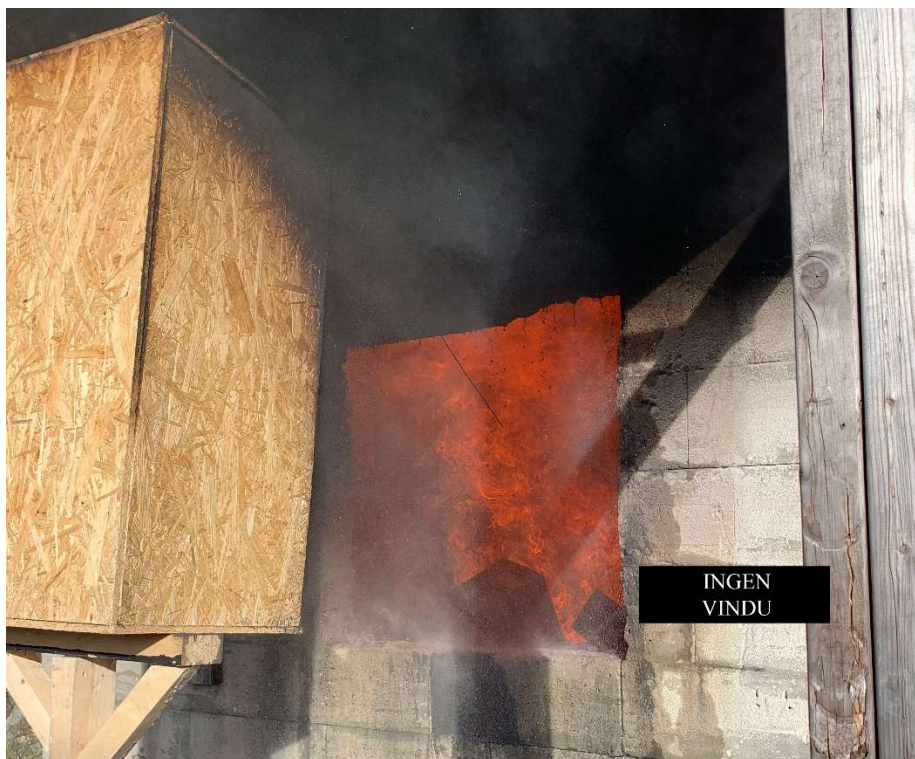
Bilde 17 - Forsøksoppsett forsøk 2. Ingen vindu installert, men sprinklerhode aktivert
