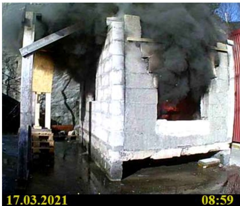
Bilde 21 - Røykproduksjon fra forsøk 1. Boks med platetermometere med flamme på toppen. 08:59 etter brannstart
