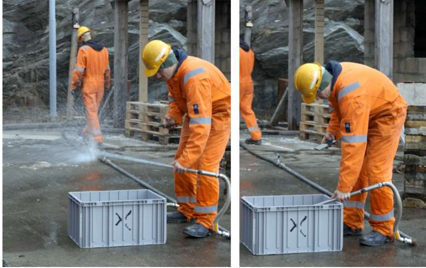
Bilde 11 - Tidtaking av sprinklerhodets egenskap til å fylle karet
