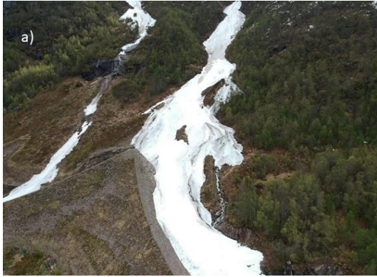
Figur 63 - a) er bilde tatt av Buskreda-plogvollen med drone 25. mai 2020, b) er simuleringene av 20-årsskred i Vette Buskreda og Store Buskreda lagt oppå hverandre. Som man ser på figurene, følger særlig skredmassene fra Store Buskreda lignende bevegelsesmønster i simuleringen og i virkeligheten.
