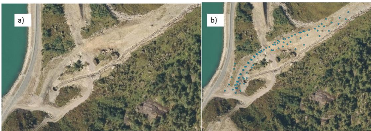
Figur 26 – a) Flyfoto av ledevollen ved Linnskreda, bilde b) viser med målepunkt i blå (Kartverket, 2020b).
