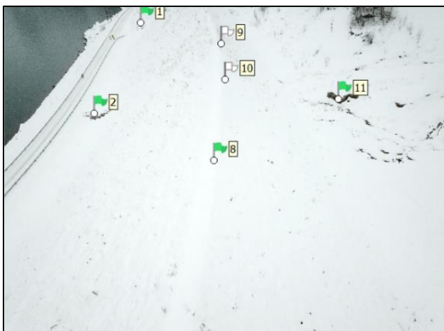
Figur 32 - Viser markering av punkt i Metashape. De grønne flaggene viser punkter som er festet til dGPS-punktet på dette bildet, mens de hvite viser punkt som ikke er festet.
