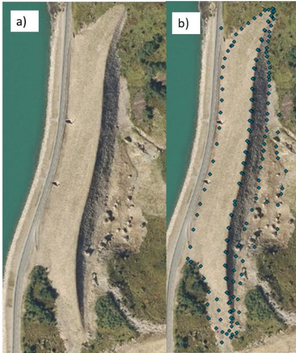
Figur 27 – a) Flyfoto av Linnskreda-fangvollen, bilde b) viser med målepunkt i blå (Kartverket, 2020b).
