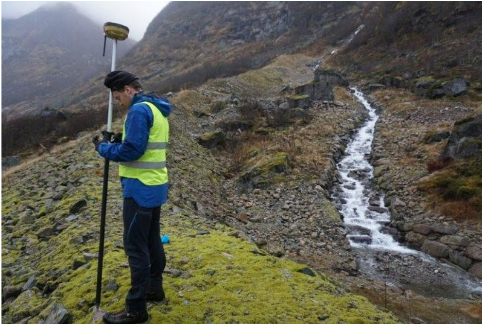
Figur 21 – Viser RTK-mottaker som er koblet mot CPOS-nettet og GPS (Foto: privat).
