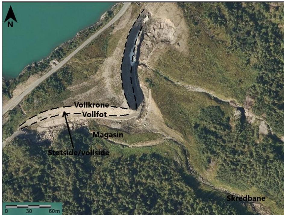
Figur 14 - Avbildet er Buskreda-plogvollen med vullkrone og vullfot markert med svart stiptet linje, magasin og støtside/vollside. Bakgrunnskart fra www.norgebilder.no .
