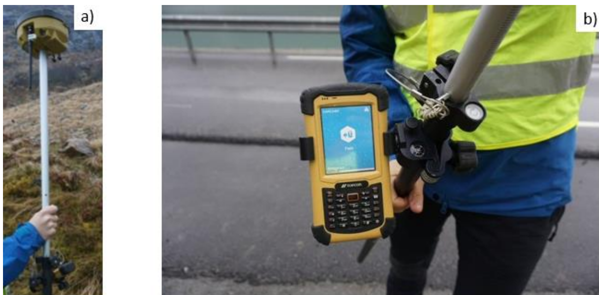
Figur 23 – Bilde a) viser mottakeren Topcon HiPer V på toppen av stangen. Bilde b) viser målebok av typen Topcon FC336 som brukes til å justere innstillinger og foreta målinger (Foto: privat).
