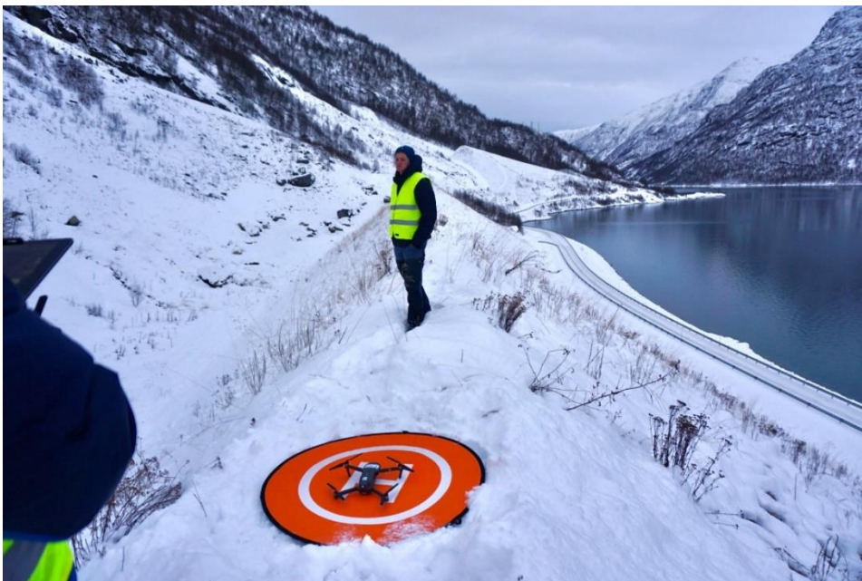
Figur 28 - Viser datainnsamling av snødekte skredvoller med drone (Foto: privat).
