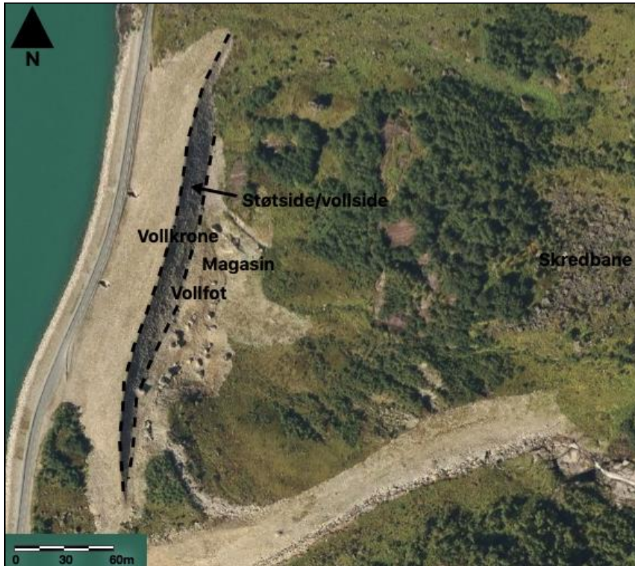
Figur 16 - Avbildet er Linnskreda-fangvollen (Kartverket, 2020b) med inntegnet vollkroner og vollfot i svart stiplede linje og magasin og støtside/vollside markert.
