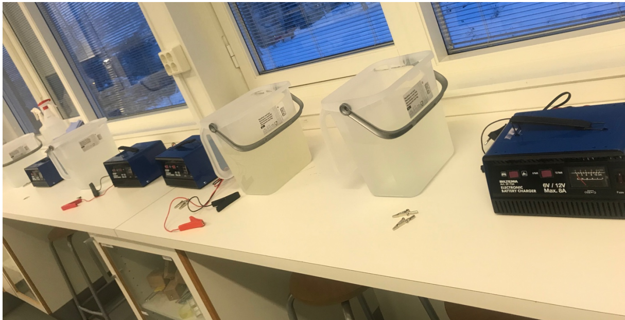
Figur 11. Elektroetsestasjoner klar til bruk på naturfagslaben.
