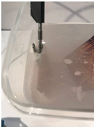
Koblet til strøm. Det bruser ved katoden
