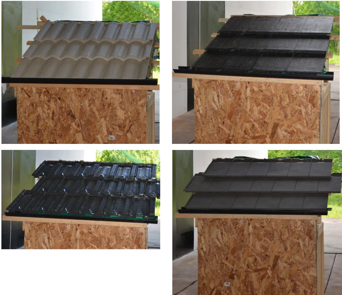
Figur 4.49 Taksegment med profilerte betongtakstein (øverst venstre), flate betongtakstein (øverst høyre), profilerte terrakottatakstein (nederst venstre) og flate terrakottatakstein (nederst høyre). Hentet fra [99].
