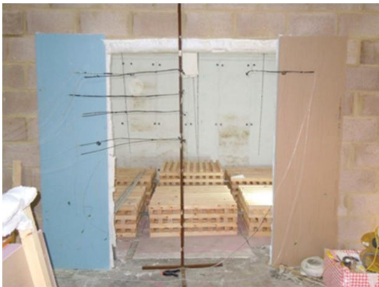
Figur 4.10 Brannenergi/Treverk på gulvet i brannrommet. Hentet fra [54], © Building Research Establishment Ltd 2015
