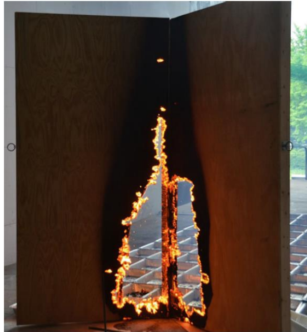
Figur 4.18 Forsøk med innvendig hjørne av kryssfinér på trestendere. Oppsamlingspanner for flyvebrannpartikler bak konstruksjonen. Hentet fra [75].
