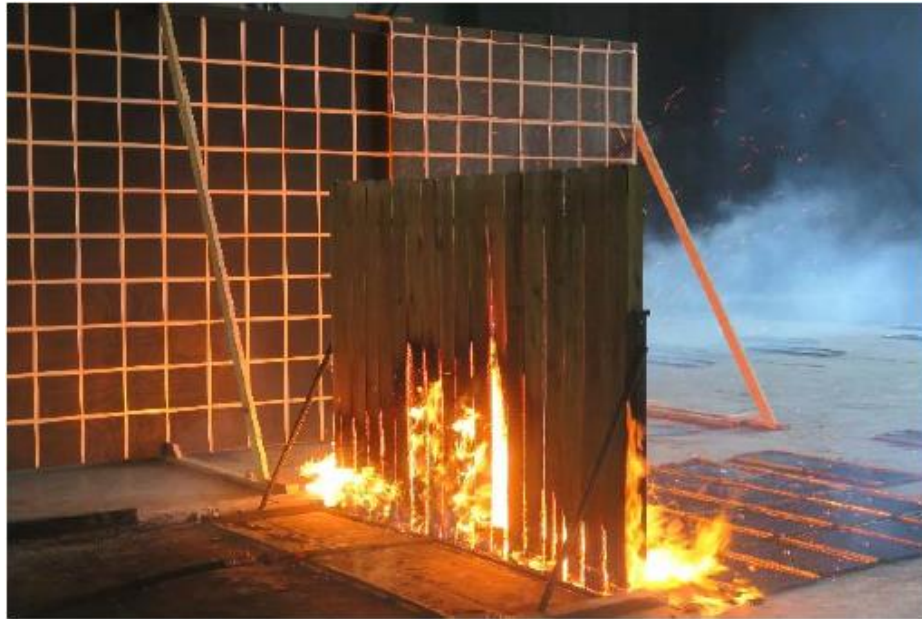
Figur 4.25 Forsøk med "lukket" gjerde med vertikale bord. Hentet fra [78].
