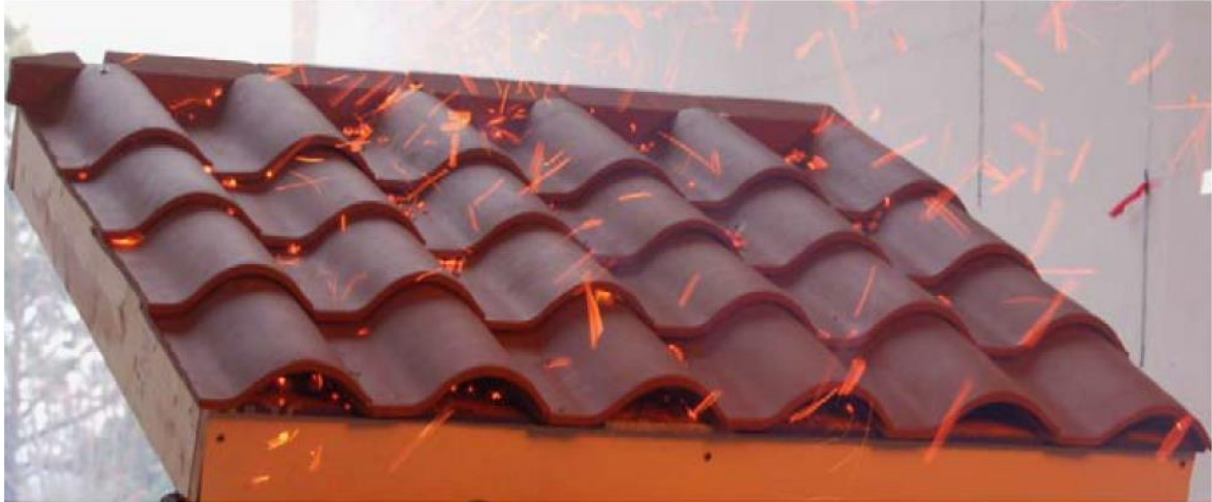
Figur 4.48 Taksegment eksponert for flyvebrann. Hentet fra [98].
