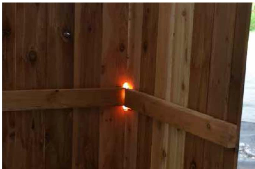
Figur 4.55 Antennelse i sprekker i gjerdet. Hentet fra [80].
