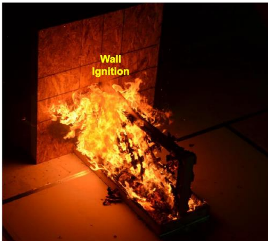
Figur 4.45 Brannsmitte til vegg fra brennende gjerde montert til veggen. Hentet fra [81].
