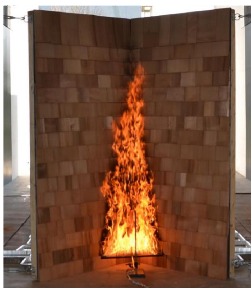
Figur 4.20 Forsøk med innvendig hjørne av trestendere, OSB-plater, tjæreapp og kledning av treplater. Hentet fra [76].
