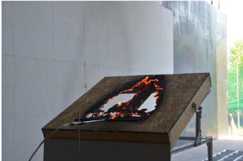
Figur 4.22 Forsøk med takkonstruksjon. Hentet fra [77].
