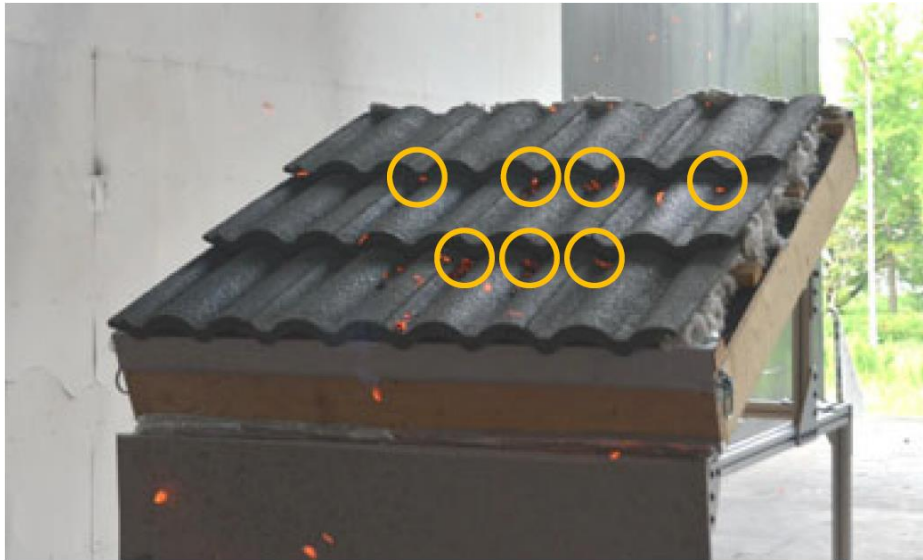
Figur 4.50 Akkumulering av flyvebrann i sprekker på profilerte betongtakstein. Hentet fra [100].
