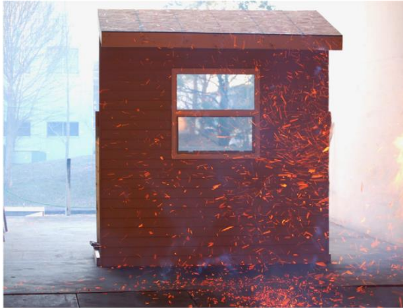
Figur 4.47 Veggsegment med vindu eksponert for flyvebrann. Hentet fra [97].
