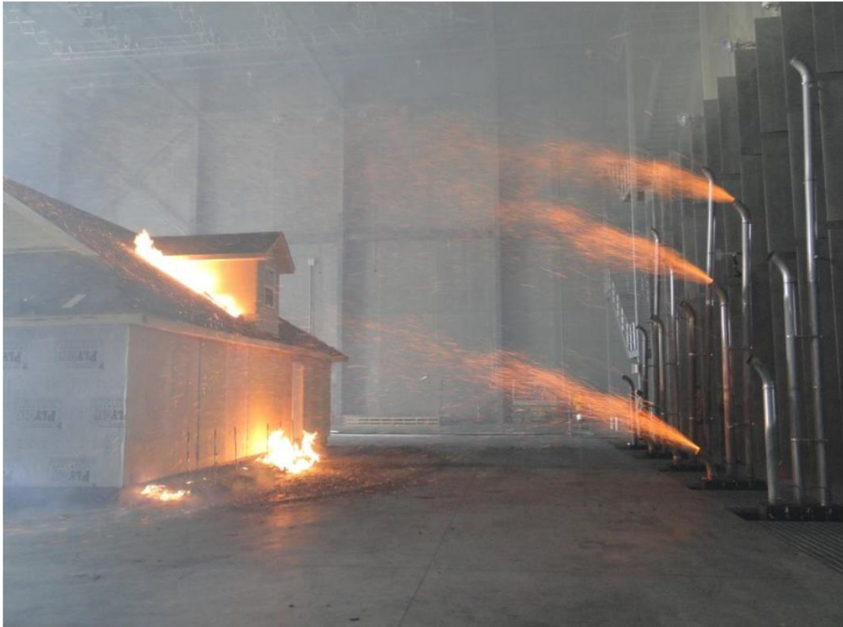
Figur 4.42 Antennelse av vegetativt rusk i grensesnitt mellom tak og vegg på saltaksark, samt i blomsterbeddekkede ved grunnmur. Hentet fra [93].
