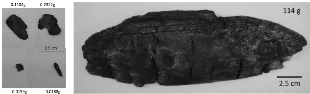
Figur 4.31 «Normale» flyvebrannpartikler sammenlignet med den største flyvebrannpartikkelen funnet etter brannen i Itoigawa. Hentet fra [83].
