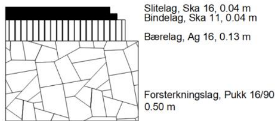
Figur 31: Overbygning parsell vest (Skjermdump Autocad)
