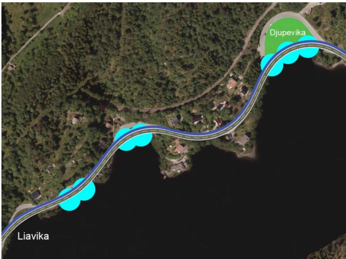
Figur 54. Skissert løsning med cellespunter markert i turkis og nytt landområde i grønt (Skjermdump Autocad).
