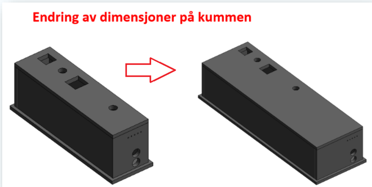
Figur 53: Viser hvordan kummen endrer seg om bunnplattens bredde endrer seg i scriptet. Topplaten og vegger vil følge endringene av dimensjoner på bunnplaten, mens utsparinger vil flytte seg slik at målsettingene ikke endres.
