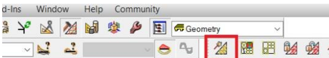
Figur 16: Viser hurtigtasten for å utføre mesh i Robot.
