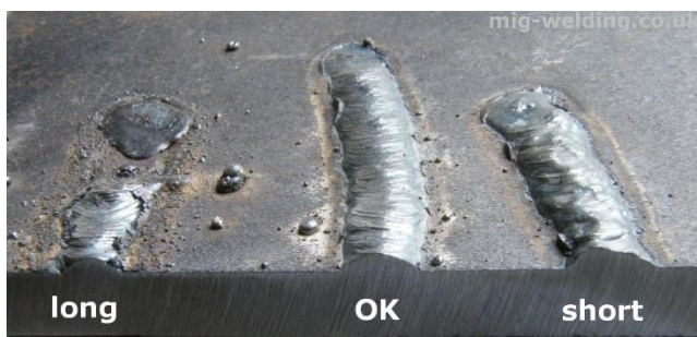
Figur 9. Resultater av for lang, OK og kort avstand ved sveising [14].
