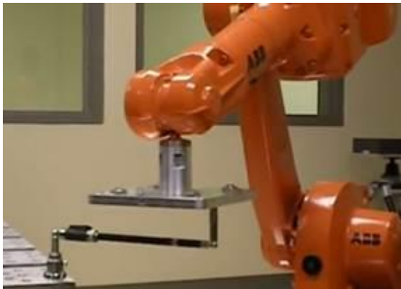
Figur 47. ABB-robot som utfører ballbar test [66].
