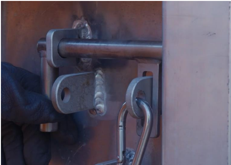
Figur 43. Bilde av dørlås hvor det må sveises manuelt på PUSH-IN containeren [7].
