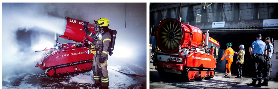
Figur 5-1 LUF60 sløkkerobot Kilde: Hentet med tillatelse fra [40]
