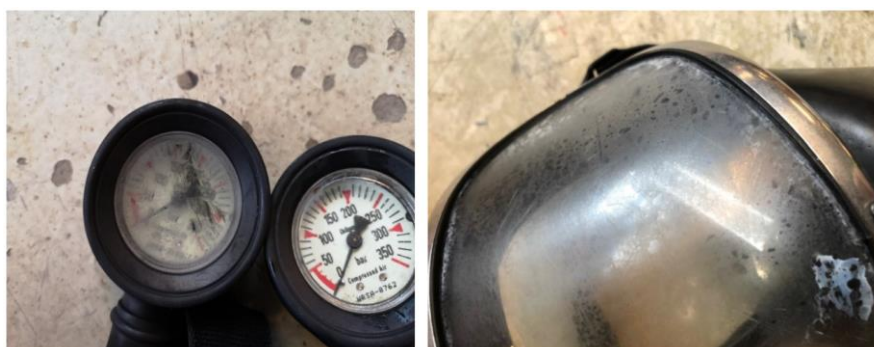
Figur 4-6 Etseskader på røykdykkerutstyr etter innsats på MF Ytterøyningen Kilde: Hentet med tillatelse fra [5]
