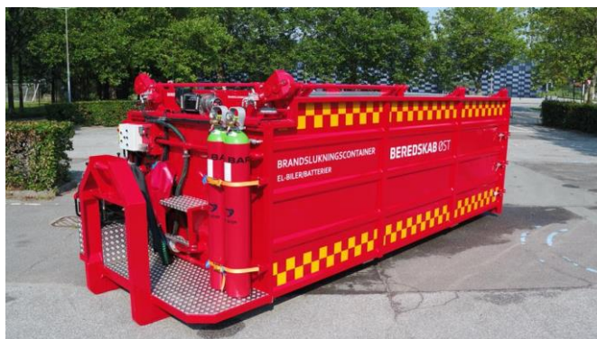
Figur 5-2 Brannslukkingscontainer for elektriske kjøretøy Kilde: Henet fra [41]
