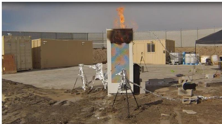
Figur 23 - Flammehøyde ved første jetflamme under forsøk 2 [35]
