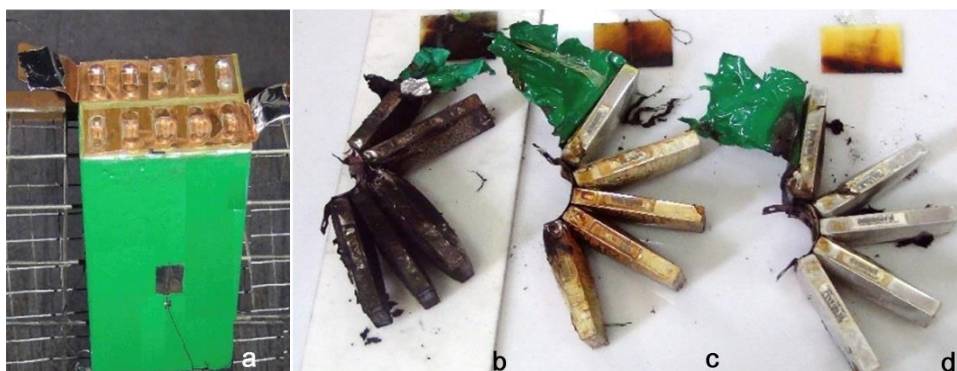
Figur 20 - Batteripakken fra forsøk 1 før testing og etter testing [13]
