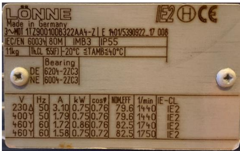
Figur 4.6: Merkeskilt asynkronmaskin på modellen, (foto: CompactHydro)
