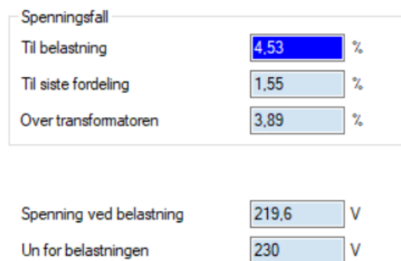
Figur 24: Spenningsfall frem til IT-tavle (4,53%), fra IT-tavle til utstyr (1,55%) og over transformator (3,89%)
