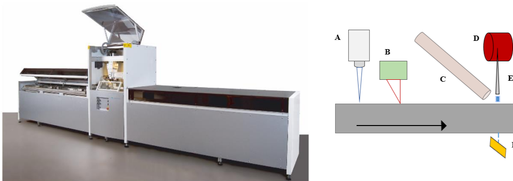
Figur 18: Bildet til venstre viser ITRAX-flerfunksjonell skanner sette forfra. Hentet fra Croudace et al. (2006). Bildet til høyre viser oppsett av ITRAX-systemet med A: optisk kamera, B: lasertrianguleringssystem, C: XRF detektor, D: Røntgenkilde, E: røntgenfokuserende spalte, F: Røntgendetektor og den horisontale pilen: viser bevegelsesretningen for sedimentkjernen. Laget ut fra Croudace et al. (2006).
