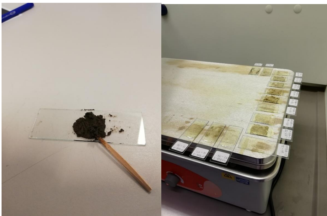
Figur 21: Bildet til venstre viser homogenisering av sedimentmassen. Bildet til høyre viser oppvarming og nedkjøling av preparatene.
