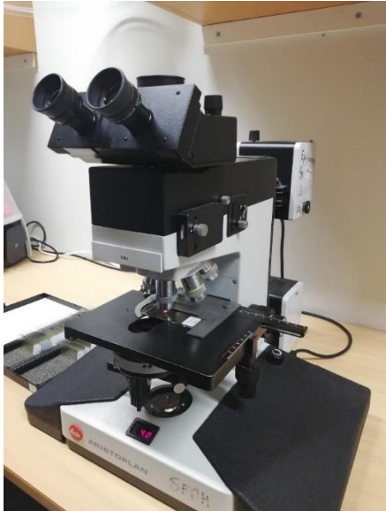
Figur 22: Bildet viser Leitz Aristoplan mikroskopet som ble brukt til alle analyser av smøpreparatene.
