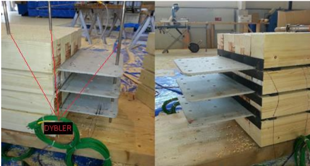
Figur 21-Limtresøyle C før montering
