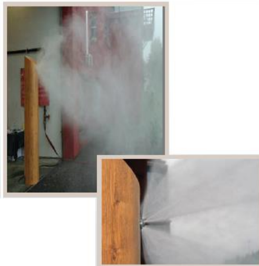
Figur 10 - Når Q1 aktiveres spres vanntåke gjennom dysen [49] (med godkjenning fra E. Nilsen [49])
