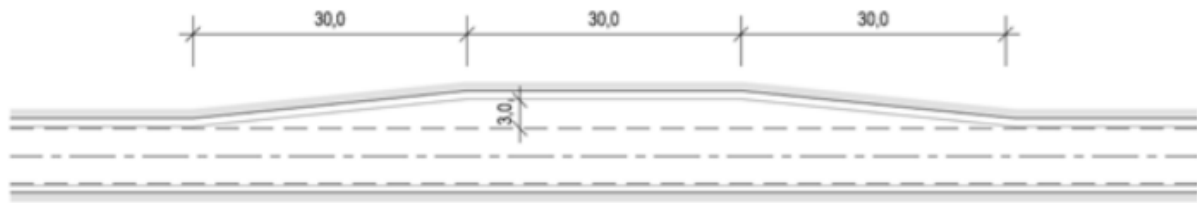
Figur 27: Utforming av havarinisje [103]
