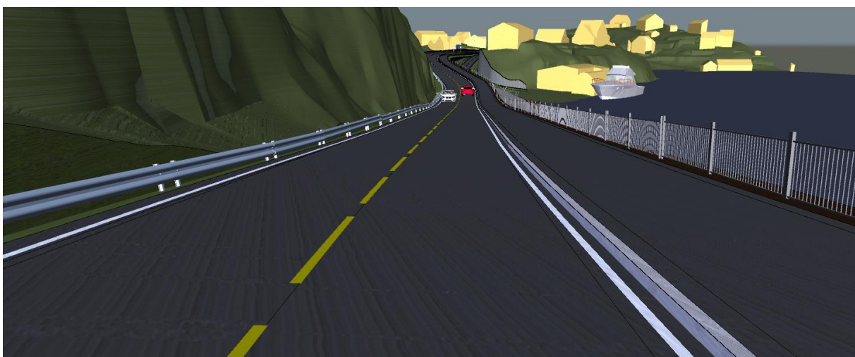
Figur 33: Illustrasjon av rekkverk. (Skjermdump Navisworks)
