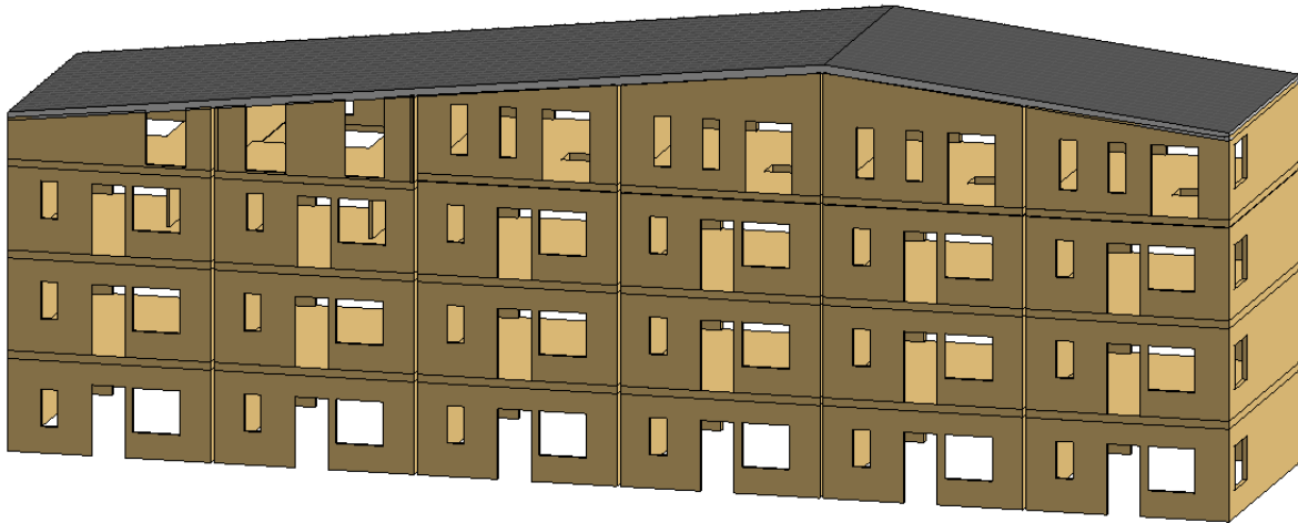
Figur 3: Bakken bæresystem massivtre med yttervegger
