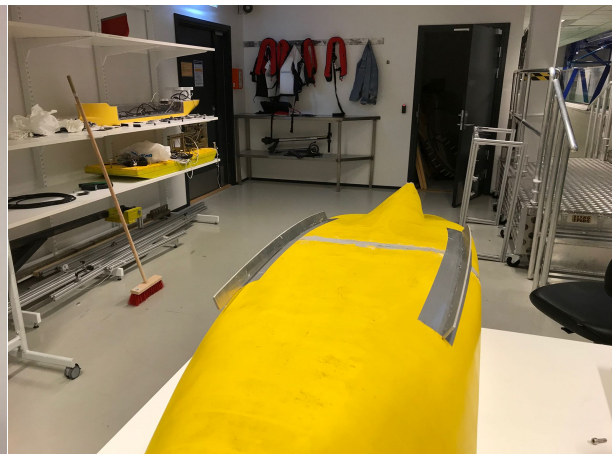
Figur 8, Slingrekjøel alt. 2 montert
