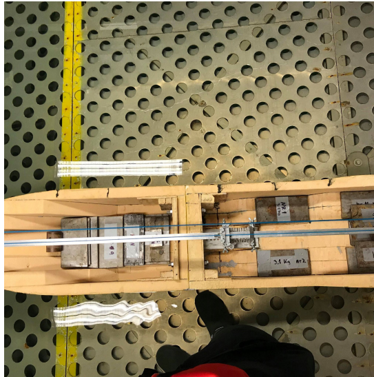
Figur 12, Slepegir og ballastering
