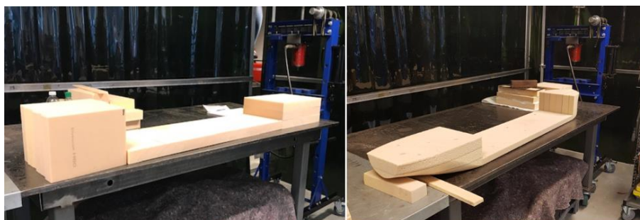
Figur 2-3: Modellen før og etter fresing
