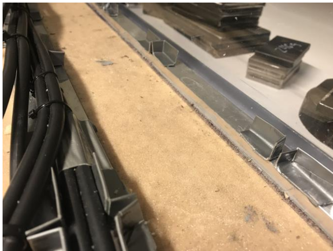
Figur 2-6: Hver tank har fast plass ved hjelp av hjørner som er limt fast.
