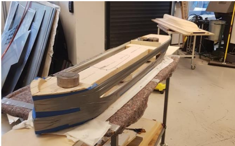
Figur 2-5: Modellen blir limt sammen og påføres press med gaffateip. Det brukes maskeringsteip under fordi den ikke fester seg like godt som gaffateipen og ødelegger derfor ikke modellen.
