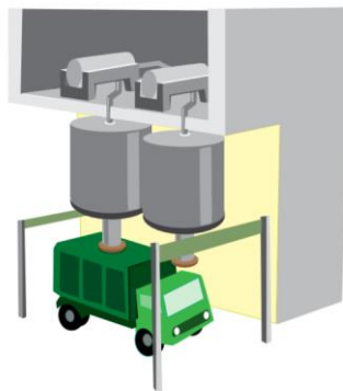
Figur 6: Sentrifugene som står over slamsiloene før det blir transportert vekk. Illustrasjon: Augon Johnsen, Bergen Kommune.
