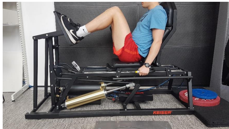
Figur 3: Utgangsposisjon i beinpresstesten
