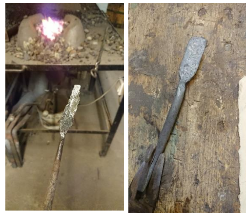
Bilde 13 Arbeid med tuppen av kroken.
