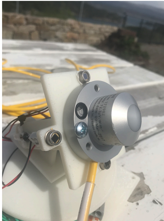
Figur 22 Skygge under pyranometer, 4. mai 2019
