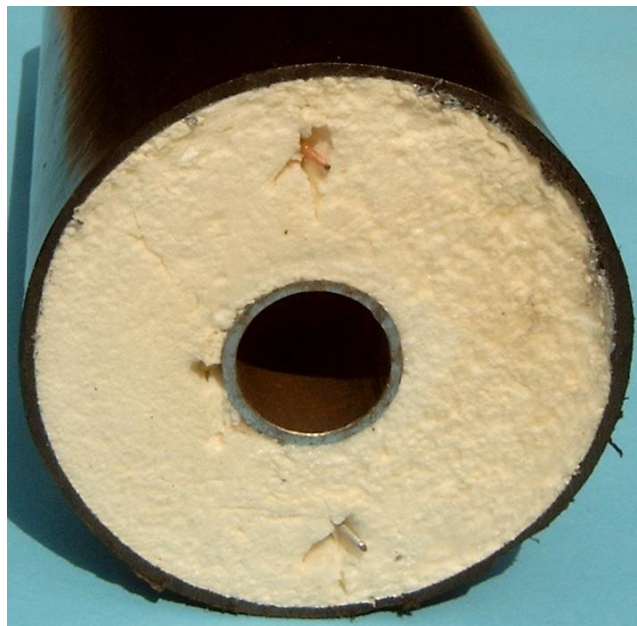
Figur 19: Polyuretan brukt som isolasjon rundt rør (Kraft, 2009)
