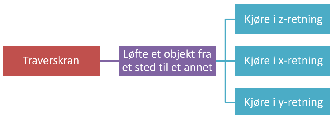
Flytskjema 4.2 Funksjonstre (traverskran)
