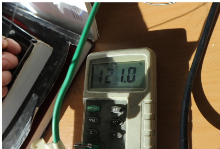
Temperaturmåling på 121 °C kort tid (omtrent 15-20 sekunder) etter termoelement var plassert i brennpunkt. Temperaturen økte hele tiden.
