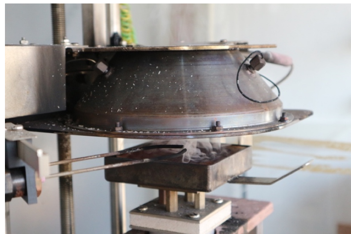
Prøvestykket begynte å ryke etter omtrent 1 minutt. Ble aldri antent.
