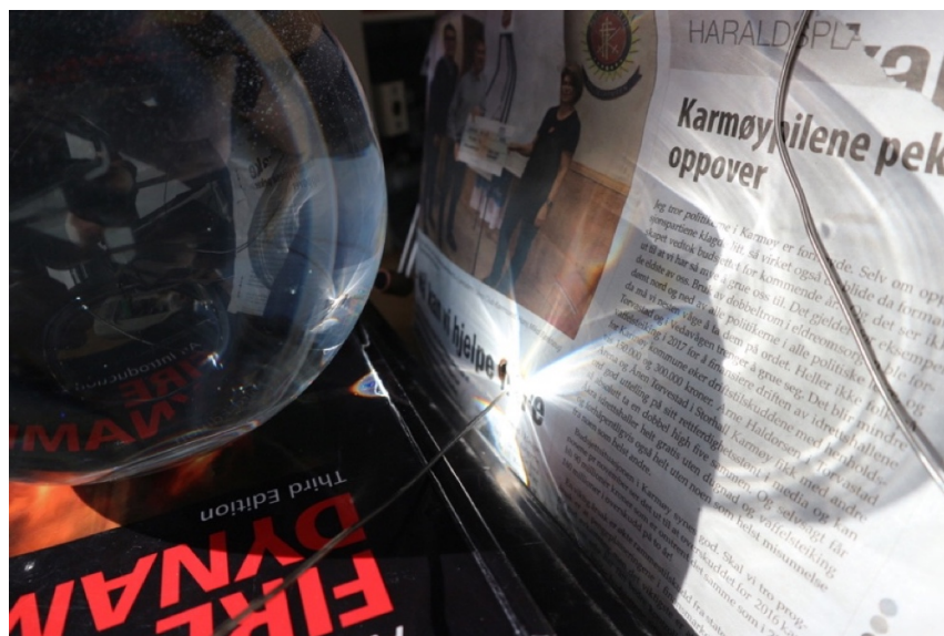
Temperaturmåler plassert i brennpunkt gjennom vassen. Her har avispapiret tatt fyr.
