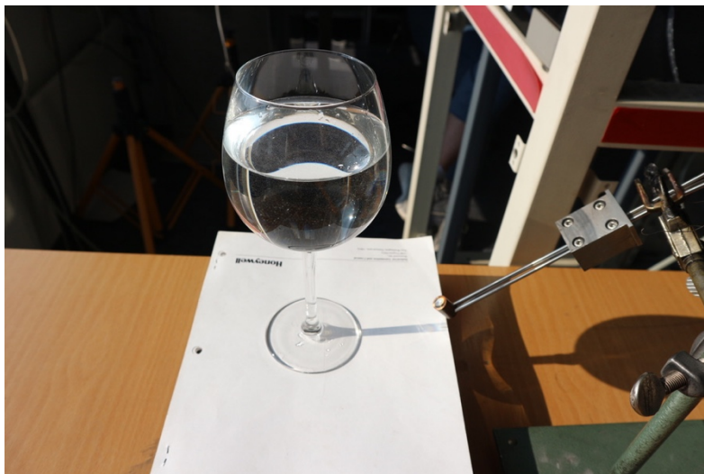
Strålefluksmåler plassert i brennpunkt gjennom vinglasset.
