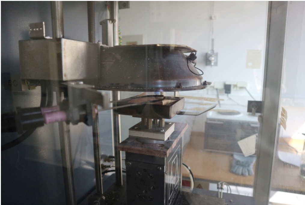
Prøvestykket begynte å ryke umiddelbart ved eksponering for strålefluks.
