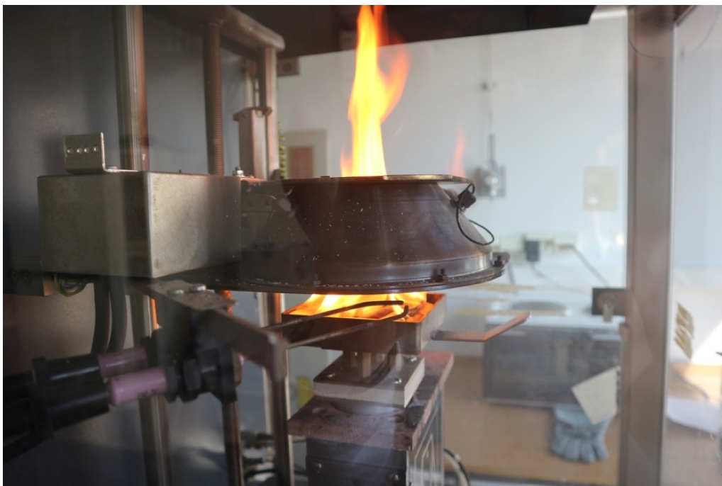
Prøvestykket antente etter 2-3 sekunder.
