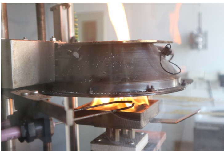
Prøvestykket antente etter 20 sekunder.
