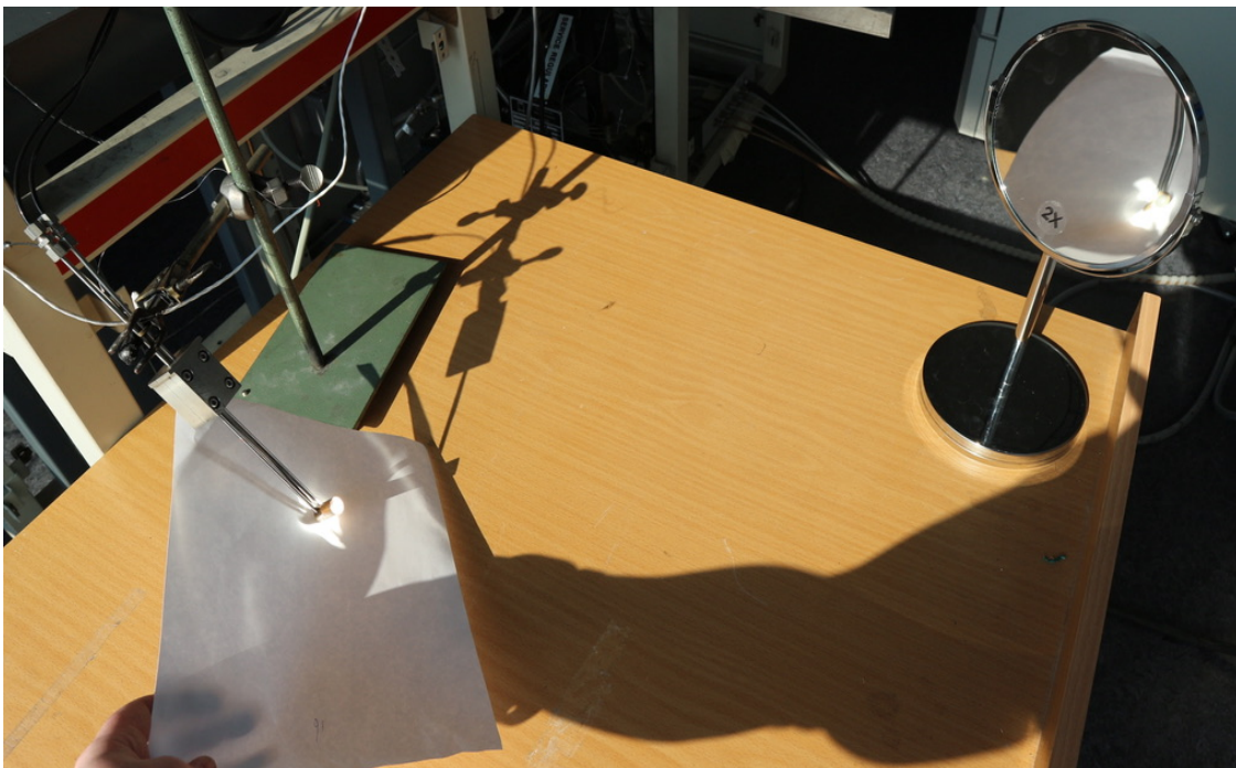
Strålefluksmåler plassert i brennpunkt som dannes ved refleksjon i speilet. Her med et hvitt A4-ark under slik at brennpunktet ble mer synlig.
