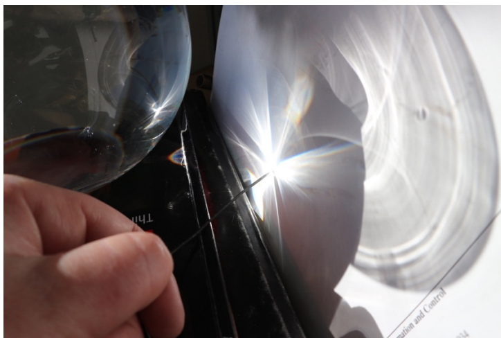
Temperaturmåling i brennpunkt gjennom kulevasen.
