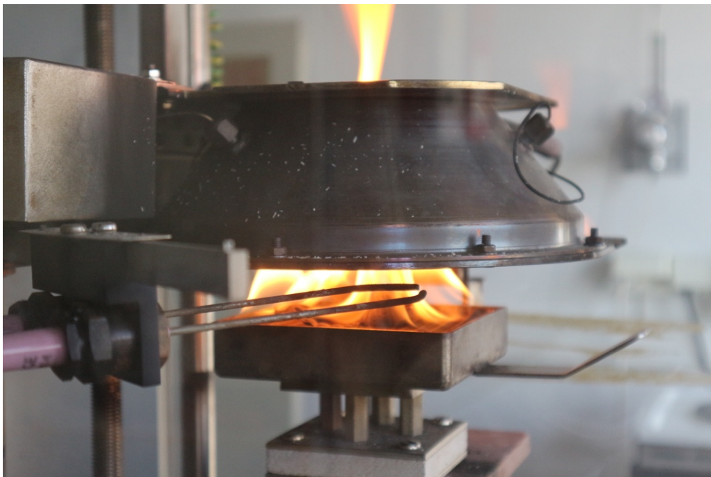
Prøvestykket antente etter 8-9 sekunder.
