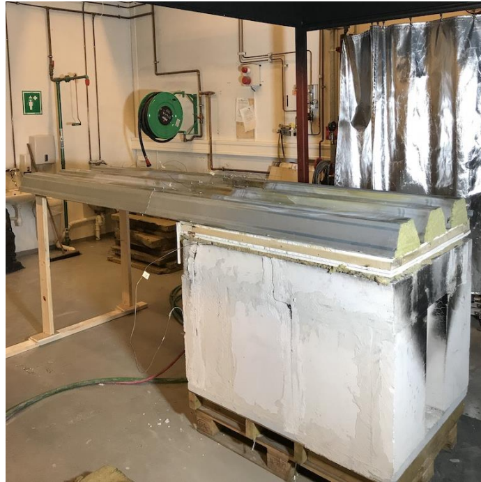
Figur 21 - Forlengelse av stålplatetaket
