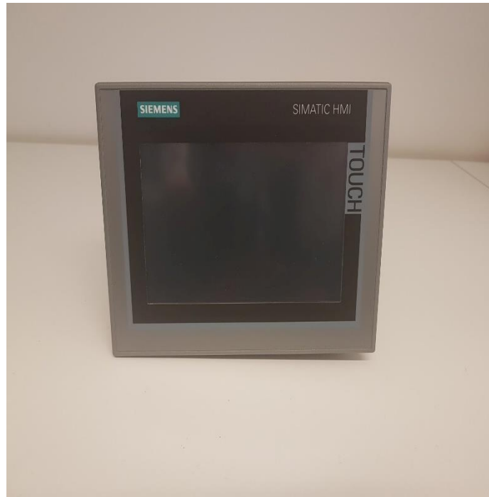
Figur 9: HMI-panel brukt i løsningen
