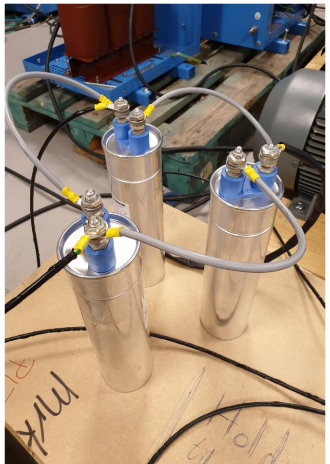
Figur 24: Tekniske spesifikasjoner til kondensator Figur 25: Kondensatorer tilkoblet system
