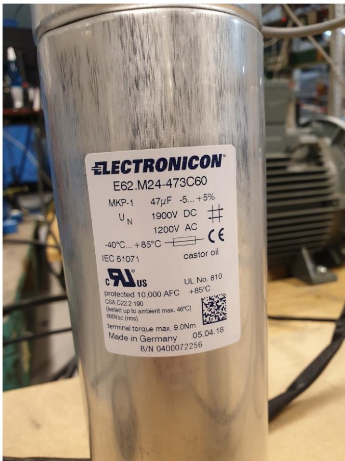
Figur 24: Tekniske spesifikasjoner til kondensator Figur 25: Kondensatorer tilkoblet system
