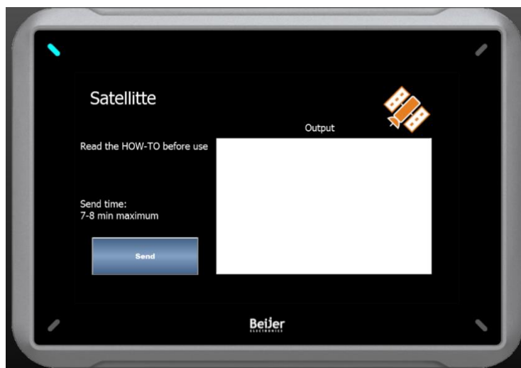
Figur 3 – Bilde av HMI hvor bruker kan starte en sending og få tilbakemeldinger om sendingen.
