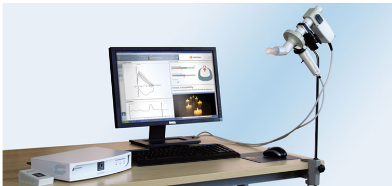
Figur 7 Fremstilling av Vyntus Pneumo, her tilkoblet datamaskin med grafisk fremstilling. Fra Carefusion, 2017. Hentet fra https://www.vyaire.com/Documents/international/specifications/respiratory-care/cardiopulmonary/SeS%202.21_Vyntus%20EU_TechSpec_EN_Final.pdf
