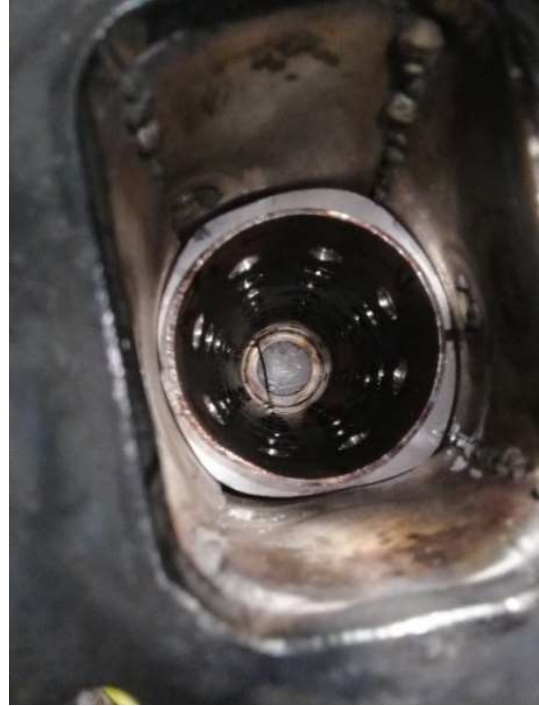
Figur 24: Flammerør montert i casing med modifikasjoner
