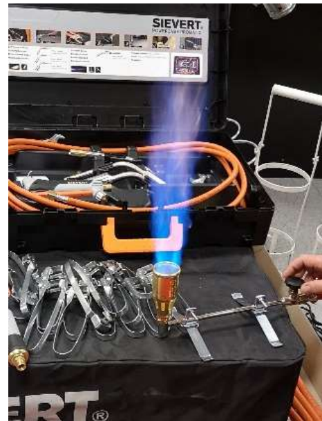
Figur 9: Ny dyse med brennerhette
