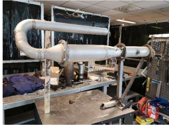
Figur 14: Nytt brennkammer montert på stativet
